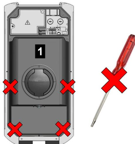
Fig. 1-1: Tornillos de la parte frontal
